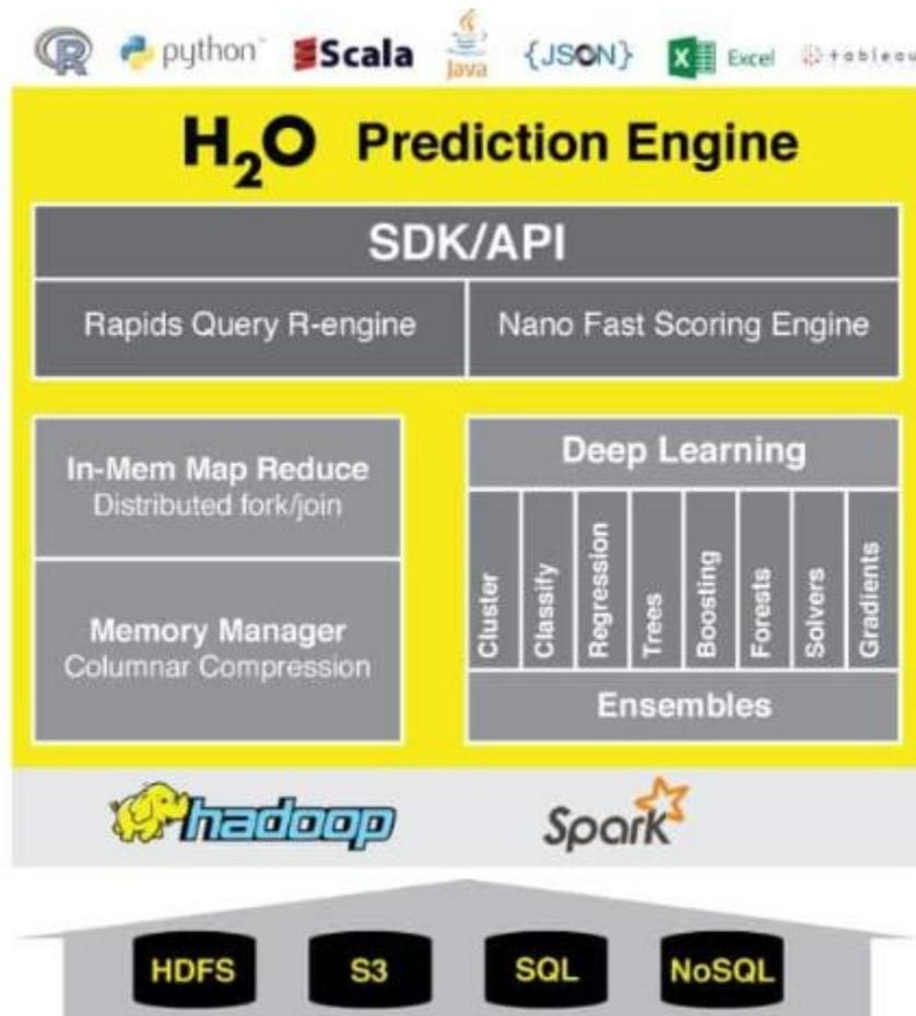
Figura 15: Estructura del motor de predicción H2O
